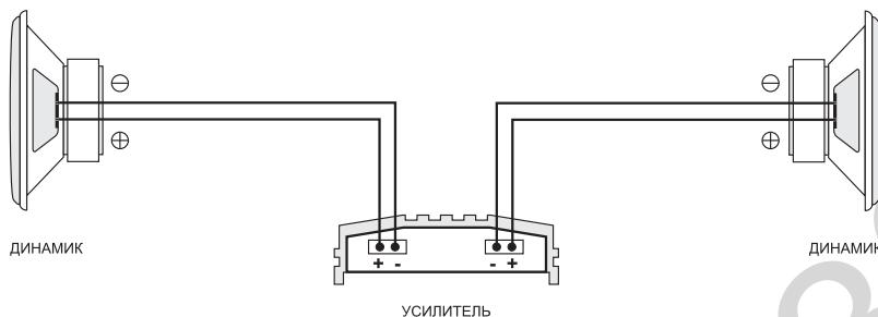
B) Схема подключения компонентных динамиков.
