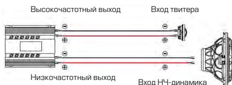
Двухканальный усилитель с кроссоверной фильтрацией выходов с минимальной частотой 2500 Гц
