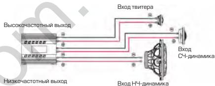
Двухканальный усилитель с кроссоверной фильтрацией выходов с минимальной частотой 2500 Гц
