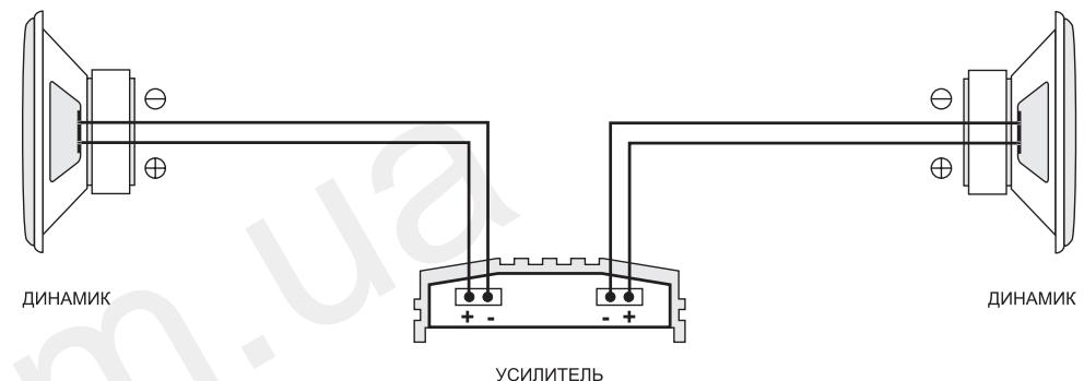
B) Схема подключения компонентных динамиков.
