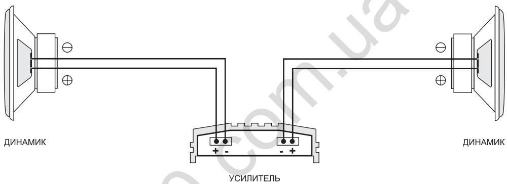
B) Схема подключения компонентных динамиков.
