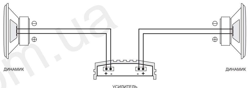
B) Схема подключения компонентных динамиков.
