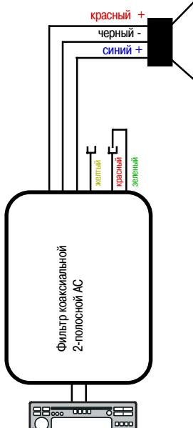
На кабельном фильтре без винтовых разъемов выбор уровня твитера осуществляется извне путем подсоединения зеленого провода к красному или желтому выводу корпуса фильтра.
