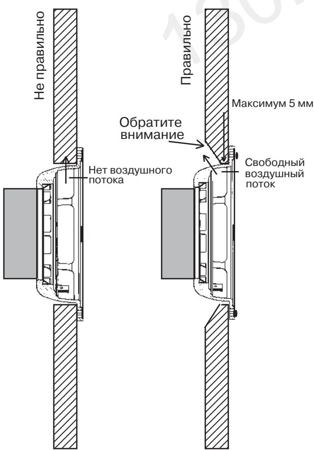
Просверлите отверстие в обшивке двери диаметром 46 мм / 1.77". Прикрепите динамик твитера к обшивке двери (или к другой поверхности, на которой вы хотите установить динамик) с помощью четырех длинных винтов.
