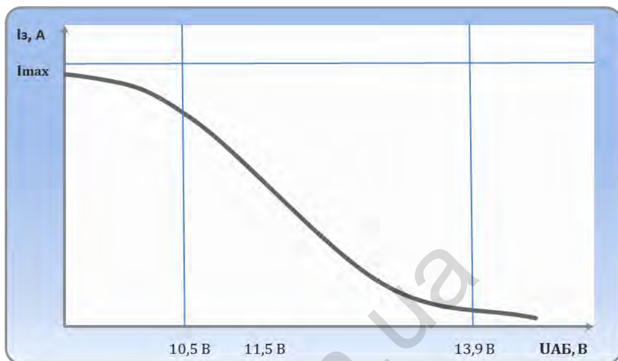
Рис.2. График работы зарядного устройства.
