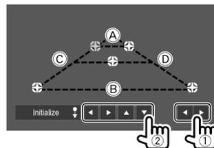
Убедитесь в том, что линии **A** и **B** горизонтально параллельны друг другу и что линии **C** и **D** имеют одинаковую длину.
