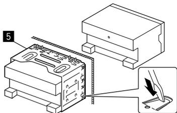
Согните щитки монтажной муфты с помощью отвертки или аналогичного инструмента и установите ее на место.
