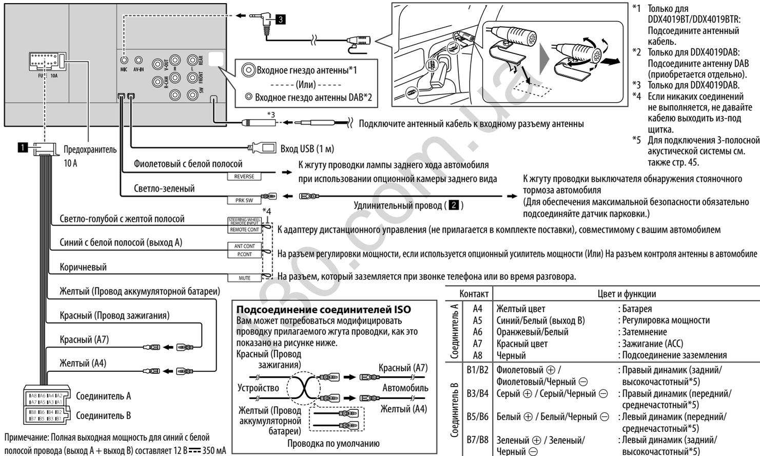
Примечание: Полная выходная мощность для синий с белой полосой (выход A + выход B) составляет 12 В === 350 мА
