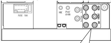
Предвыход высокочастотного динамика
