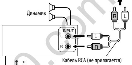
\* При подсоединении внешнего усилителя подсоединяйте его провод заземления к шасси автомобиля.
