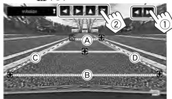
Убедитесь в том, что линии **(A)** и **(B)** горизонтально параллельны друг другу и что линии **(C)** и **(D)** имеют одинаковую длину.
