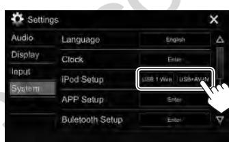
**[USB 1 Wire]** Выбирайте эту опцию, когда iPod/iPhone подсоединен с помощью KS-U62 (опционная принадлежность) или кабеля USB с 30-контактным разъемом (принадлежность iPod/iPhone).
