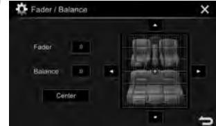
**Fader:** Настройка баланса выходного сигнала для передних и задних динамиков.
