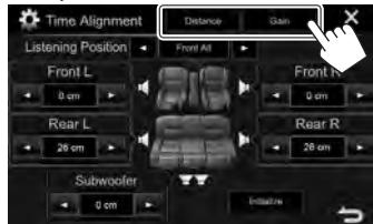
**[Distance]** Настройка значения цифровой регулировки запаздывания (DTA).
