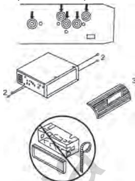
1. Выберите позицию, при которой винтовые отверстия кронштейнов и винтовые отверстия ресивера совпадут, и закрепите ресивер при помощи винтов (5x5 мм) с каждой стороны.
