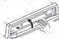
Для снятия передней панели нажмите кнопку REL (2) в верхнем левом углу.
