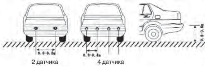
Перед установкой датчиков убедитесь в отсутствии ложных срабатываний от элементов, выступающих из задней части автомобиля (кронштейны крепления запасного колеса, прицепное устройство).
