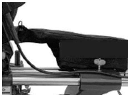
La sierra viene equipada con una bolsa colectora para serrín y virutas.
