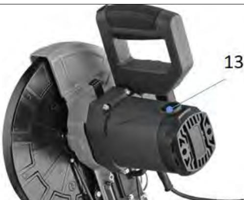
Überprüfen Sie die Kohlebürsten nach den ersten 50 Betriebsstunden mit einer neuen Maschine oder wenn neue Bürsten montiert sind. Nach Durchführung der ersten Kontrolle wiederholen Sie die Kontrolle alle 10 Betriebsstunden.
