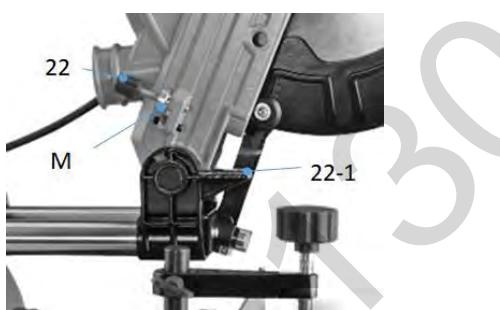
La profundidad de corte se puede ajustar gradualmente con el tornillo (22). Para ello, afloje la tuerca moleteada (M) del tornillo (22). Enrosque o desenrosque el tornillo (22) para ajustar la profundidad de corte requerida. A continuación, vuelva a apretar la tuerca moleteada (M).
