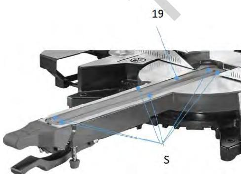
1. Schrauben (S) am Tischeinsatz (19) entfernen. Drehen Sie bei Bedarf Drehtisch und Maschinenkopf, um die Schrauben erreichen zu können.
