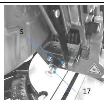
Wenn der Laser (17) nicht mehr die richtige Schnittlinie anzeigt, können Sie den Laser neu einstellen. Lösen Sie die Kreuzschlitzschrauben (S) und stellen Sie den Laser ein, indem Sie ihn seitlich bewegen, bis der Laserstrahl auf die Zähne des Sägeblattes trifft. Beide Schrauben (S) wieder fest anziehen.
