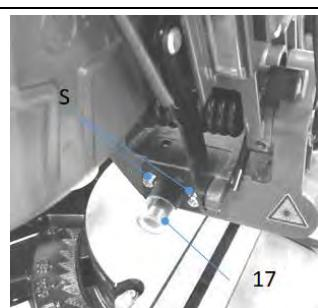
Se puede reajustar el láser (17), en caso de que no muestre la línea de corte correcta. Afloje los tornillos de estrella (S) y ajuste el láser moviéndolo hacia un lado hasta que el rayo láser alcance los dientes de la hoja de la sierra. Vuelva a apretar los dos tornillos (S).
