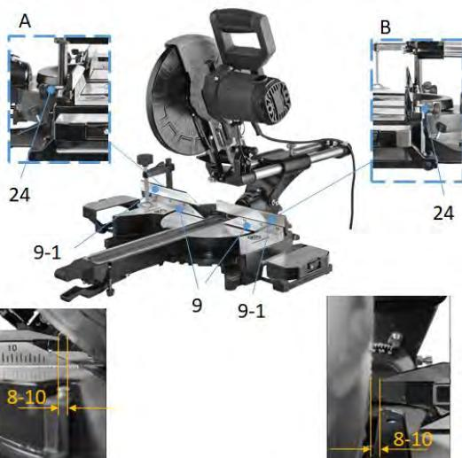
Los dos topes ajustables (9-1) se deben ajustar cada vez que se modifique el ángulo del cabezal de la máquina (90-45°). Para ello, afloje los tornillos de fijación (24) y ajuste los topes, de modo que entre la hoja de la sierra y el tope haya una distancia de 8-10 mm. A continuación, vuelva a apretar los tornillos de fijación (24) para fijar los topes (9-1).
