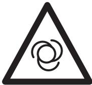
Attention! L'appareil est équipé d'un système automatique de mise en route. Veillez à maintenir les tierces personnes à distance de l'appareil !
