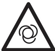
Warnung! Das Gerät ist mit einer automatisierten Anlaufsteuerung ausgestattet. Halten Sie Dritte vom Arbeitsbereich des Gerätes fern!
