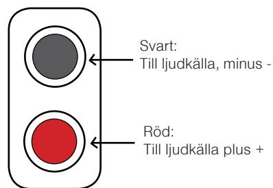
För anslutning av kabel, tryck nedåt och för in den avskalade kabeln i hålet på terminalanslutningen.
