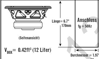
$$V_{\text{BOX}} = 0.42 \text{ ft}^3 (12 \text{ Liter})$$
