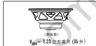
$$V_{BOX} = 1.23 \text{ 立方英尺 (35 升)}$$
