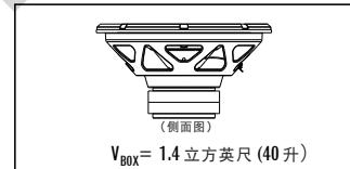
$$V_{BOX} = 1.4 \text{ 立方英尺 (40 升)}$$
