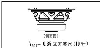
$$V_{BOX} = 0.35 \text{ 立方英尺 (10 升)}$$
