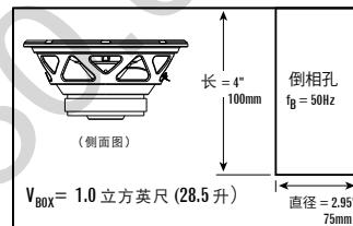
$$V_{BOX} = 1.0 \text{ 立方英尺 (28.5 升)}$$
