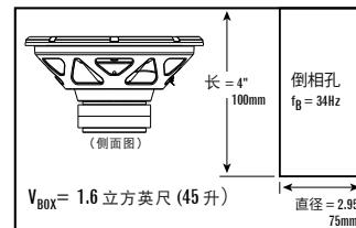
$$V_{BOX} = 1.6 \text{ 立方英尺 (45 升)}$$
