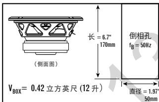
$$V_{BOX} = 0.42 \text{ 立方英尺 (12 升)}$$
