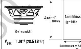
$$V_{\text{BOX}} = 1.0 \text{ ft}^3 (28.5 \text{ Liter})$$
