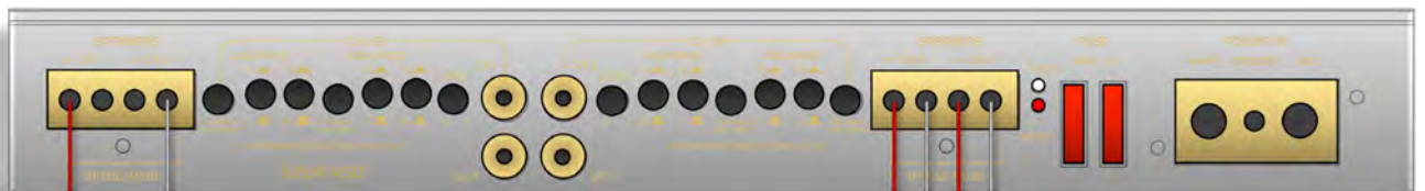
GZUA 4SQ – Stereo- und Brückenbetrieb (Beispiel)
