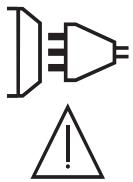
Este material no se ajusta a la norma CEI 61000-3-12 y está destinado a ser usado en redes de baja tensión privadas conectadas a la red pública de alimentación de media y alta tensión. En una red eléctrica pública de baja tensión, es responsabilidad del instalador o del usuario del material asegurarse, si fuera necesario consultando al distribuidor, de que el aparato se puede conectar.
