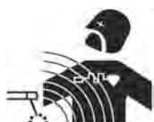
Электрический ток, проходящий через любой проводник, вызывает локализованные электромагнитные поля (EMF). Сварочный ток вызывает электромагнитное поле вокруг сварочной цепи и сварочного оборудования.
