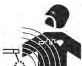
Elektrische stroom die door een geleider gaat veroorzaakt elektrische en magnetische velden. De lasstroom wekt een elektromagnetisch veld op rondom de laszone en het lasmateriaal.
