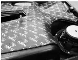
Une isolation acoustique est nécessaire afin de supprimer les vibrations dûent à la fixation du haut-parleur sur la garniture (ref. B.A.M).
