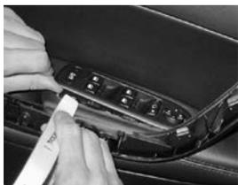
Utiliser ce même outil pour le démontage de la barre et la commande lève vitres.
