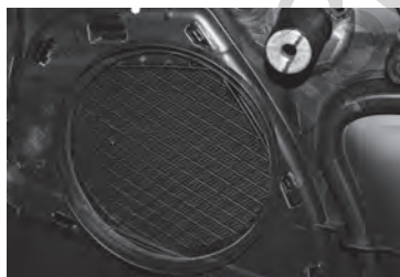
11. Emplacement dans la garniture de portière. Veillez à ce que la membrane ne vienne pas en contact avec la garniture.
