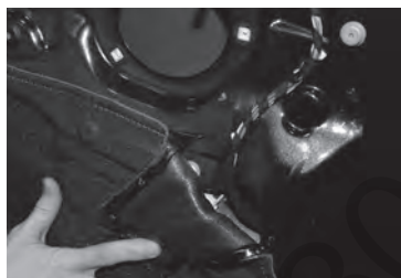
3. Décollage de la protection et passage du câble.
