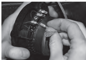
5. Connexion du connecteur sur le bornier du haut-parleur du Kit IFBMW-S.
