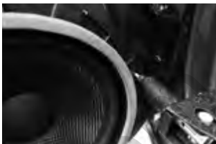
Rivage du haut-parleur IS 690TOY ou IC 690TOY (avec les rivets fournis)
