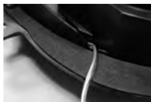
Passage du câble du connecteur dans la gorge prévue
