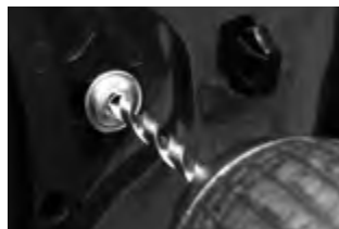
Dérivage du haut-parleur d'origine (x3 rivets/HP)
