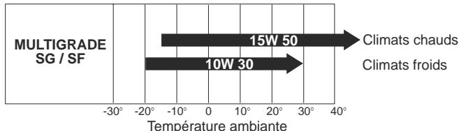
Utiliser de l'huile détergente pour moteurs à quatre temps, classe API SG ou SF (indication sur le bidon de l'huile) avec une viscosité SAE adéquate au climat d'exercice (voir tableau).
