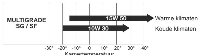
Maak gebruik van detergent-olie voor viertaktmotoren, klasse API SG of SF (aangegeven op oliecontainer) met een SAE-viscositeit die geschikt is voor het klimaat (zie tabel). Om de olie er gemakkelijker uit te laten lopen kunt u de motor ongeveer 3 - 5 minuten laten lopen. Vervolgens loost u de olie terwijl de motor nog warm is, zodat de olie na het verwijderen van de afvoerklep (nr. 8 fig 8 en 15) sneller en vollediger via de afvoerpijp (nr. 2 fig. 8 en 15) naar buiten stroomt.
