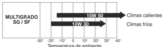
Utilice aceite detergente para motores de cuatro tiempos de clase API SG o SF (indicación sobre el bote del aceite) con viscosidad SAE adecuada al clima de ejercicio (véase tabla).
