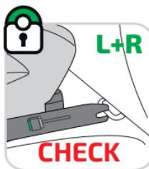
Bitte prüfen Sie anhand der Sicherheitsindikatoren an **BEIDEN SEITEN**, ob der Sitz richtig mit den beiden ISO-FIX-Ankern (**IA**) des Autos verbunden ist.
