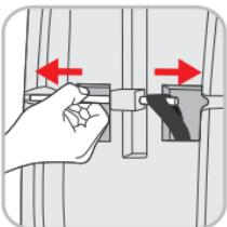
Dann haken Sie die Schulterpolstergurte (**SG**) aus dem Verbindungshaken (**VH**) aus.
