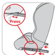
Протяните ремень TOP-TETHER над автокреслом. Для того, чтобы разблокировать замки (**IK**) ISO-FIX-коннекторов (**IM**), чуть прижмите автокресло **HEYNER® MultiRelax AERO Fix** к сидению автомобиля и нажмите на кнопку регулировки ISO-FIX-коннекторов (**IE**) по длине. Максимально вытяните ISOFIX-коннекторы из автокресла до тех пор пока вы не увидите зеленые цветовые индикаторы.
