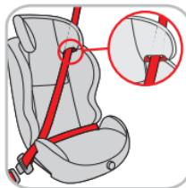
**ACHTUNG:** Der Gurt darf sich nicht verdrehen. Um einen optimalen Gurtverlauf zu gewährleisten, muss die Kopfstütze korrekt an das Kind angepasst sein.
