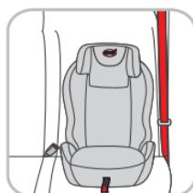
Теперь Вы можете полностью снять 5-ти точечные ремни безопасности с автокресла. Центральная лямка натяжения ремней (G5) может быть убрана под крышку механизма фиксации натяжения ремней (F).
