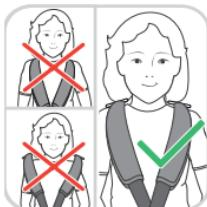
Die Kopfstütze kann in 10 verschiedene Positionen erfolgen. In Gruppe I können 5 verschiedene Höhen eingestellt werden. Wenn der 5-Punkt-Gurt entfernt wird, stehen 5 weitere Positionen zur Verfügung. Überprüfen Sie den Verlauf der Gurte und die Höhe der Kopfabstützung von Zeit zu Zeit und passen Sie diese dem wachsenden Kind an.
