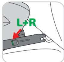
Теперь Вы можете нажать на кнопки (**IK**) замков системы ISOFIX для того, чтобы отсоединить ISO-FIX-коннекторы автокресла от ISOFIX-кронштейнов (**IA**) автомобиля.
