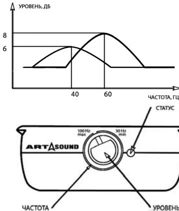
Дистанционный регулятор, входящий в комплект поставки, позволяет с водительского места регулировать уровень и частоту регулировки низкочастотного сигнала. Внешняя ручка изменяет опорную частоту, а внутренняя ручка изменяет уровень баса. Зеленый светодиод сигнализирует о включении усилителя.
