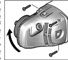
سر دستگاه را می‌توانید به اندازه 90 درجه بچرخانید. اینگونه می‌توان کلید قطع و وصل را برای حالتی های صاص کاری در وضعیت کاربری مناسبتری قرار داد، مثلاً برای برش کاری با قاب مکنده همراه با ریل راهنمای (21) یا برای چپ دستها.
