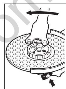
Usulüne uygun olarak takılmış ve hasarsız bir hızlı germe somununu tırtılı halkayı saat hareket yönünün tersine çevirerek gevşetebilirsiniz. **Sıkışan hızlı germe somunu hiçbir zaman bir pense ile gevşetmeyein, iki pimli anahtarları kullanın.** İki pimli anahtarları resimde görüldüğü gibi yerleştirin.
