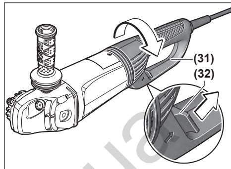
دسته اصلی (31) نسبت به بدنه موتور به مقدار 90° به چپ و راست می‌چرخد. اینگونه می‌توان کلید قطع و وصل را برای حالتی های صاص کاری در وضعیت کاربری مناسبتری قرار داد، مثلاً برای برش کاری با قاب مکنده همراه با ریل راهنمای (21) یا برای چپ دستها.
