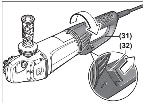
Il est possible de faire pivoter la poignée principale (31) de 90° vers la gauche ou vers la droite par rapport au carter moteur. Le fait de tourner la poignée permet, lors de certaines applications, de placer l'interrupteur Marche/Arrêt dans une position plus pratique, par ex. lors de travaux de tronçonnage avec le capot de protection avec glissière de guidage (21) ou pour les gauchers.
