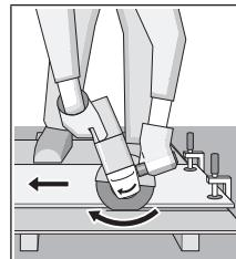
Всегда ведите электроинструмент против направления вращения. В противном случае существует опасность **не-контролированного** вырывания инструмента из прорези. При резке профилей или четырехграных труб начинайте рез на наименьшем поперечном сечении.
