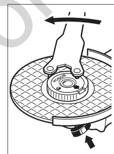
Должным образом затянутую, исправную быстрозажимную гайку можно открутить поворотом кольца с накаткой от руки против часовой стрелки. Никогда не применяйте для откручивания заклинившей быстрозажимной гайки клемши, обязательно используйте рожковый ключ под два отверстия. Накладывайте рожковый ключ под два отверстия, как показано на рисунке.
