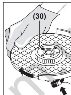
Для фиксирования шлифовального шпинделя нажмите кнопку фиксации шпинделя (1). Чтобы затянуть быстрозажимную гайку, поверните шлифовальный круг с усилием по часовой стрелке.
