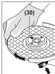
Ажарлау шпинделін (1) бекіту үшін шпиндельді бекіту түймесін басыңыз. Тез қысқыш гайканы бекемдеу үшін ажарлау дисқісін күш салып сағат тілінің бағытымен бұраңыз.
