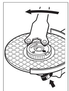
Pour desserrer un écrou de serrage rapide (non endommagé) correctement fixé, tournez avec la main la molette dans le sens antihoraire. **N'essayez jamais de desserrer un écrou de serrage rapide grippé avec une pince, utilisez uniquement la clé à ergots.** Positionnez la clé à ergots comme représenté sur la figure.
