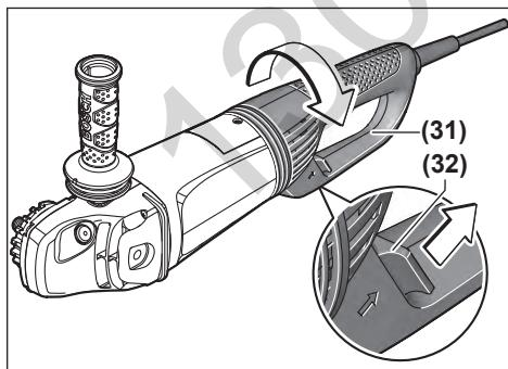
Головну рукоятку (31) можна повертати відповідно до корпуса мотора на 90° ліворуч або праворуч. Завдяки цьому вимикач буде знаходитися у більш зручному для певних видів роботи положенні, нап., для розрізання з витяжним ковпаком з люнетним супортом (21) або для лівшів.
