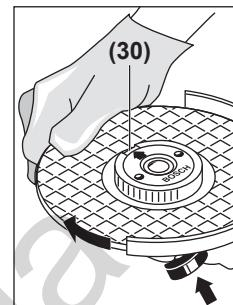
مهره مهار سریع طبق مقررات تعیین شده و بدون عیب را می‌توان با پرخاندن رینگ کنگره دار در خلاف جهت عقربه‌های ساعت با دست باز کرد. مهره مهار سریع سفت شده را هرگز توسط یک آچار شلاقی باز نکنید، بلکه از یک آچار دوسوزنه استفاده نمایید. آچار دوسوزنه را مانند تصویر در قرار دهید.
