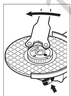
Закріплена належним чином, непошкоджену швидкозатиску гайку можна відпустити, вручну повертуючи кільце з накаткою проти стрілки годинника. **Ніколи не відкручуйте швидкозатиску гайку, яка сидить дуже міцно, кліщами - використовуйте ріжковий ключ під два отвори.** Приставляйте ріжковий ключ під два отвори, як показано на малюнку.
