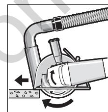
Включите электроинструмент и приставьте переднюю часть направляющих салазок к обрабатываемой заготовке. Ведите пневматический инструмент с равномерной, рассчитанной на обрабатываемый материал подачей.
