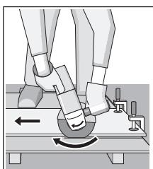
Elektrikli el aleti her zaman ters dönütte kullanılmalıdır. Aksi takdirde aletin **kontrol dışında** kesim yerinden dışarı çıkma tehlikesi vardır. Profiller ve dört köşe borular kesilirken en küçük kesiti kullanın.
