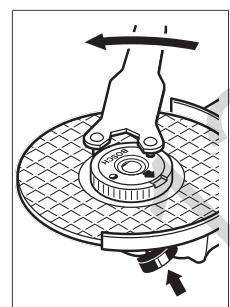
Дұрыс бекітілген, зақымдалмаған тез қысқыш гайканы сакинаны сағат тілінің бағытына қары арқылы шығаруға болады. Ешқашан қатты бекемделген тез қысқыш гайканы тістейікпен бұрап алмаңыз, екі бүйірлік тесірі бар гайка кілтін пайдаланыңыз. Гайка кілтін суретте
