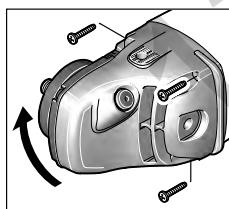
La tête de meuleuse peut être tournée par paliers de 90°. Le fait de tourner la tête permet, lors de certaines applications, de placer l'interrupteur Marche/Arrêt dans une position plus pratique, par ex. lors de travaux de tronçonnage avec le capot de protection avec glissière de guidage (21) ou pour les gauchers.
