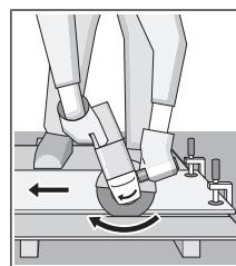
Toujours travailler en opposition (pas en avalant). Le disque risque sinon de sortir de la ligne de coupe de façon incontrôlée. Lors du tronçonnage de profilés et de tubes à section carrée, débutez au niveau de la plus petite section.
