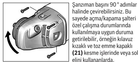
Şanziman başını 90° adımlar halinde çevirebilirsiniz. Bu sayede açma/kapama şalteri özel çalışma durumlarında kullanılmaya uygun duruma getirilebilir, örneğin kılavuz kızaklı ve toz emme kapaklı (21) kesme işlerinde veya sol elini kullanlanlarda.
