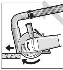
Elektrikli el aletini açın ve kılavuz kızağı ön parçasını is parçası üzerine yerleştirin. Elektrikli el aletini hafif bir bastırma kuvveti ve işlediğiniz malzemeye uygun bir tempo ile itin.
