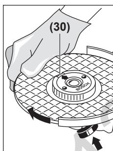
Натисніть на фіксатор шпинделя (1), щоб зафіксувати шліфувальний шпиндель. Для затягнення швидкозатискої гайки із силою поверніть шліфувальний круг за стрілкою годинника.
