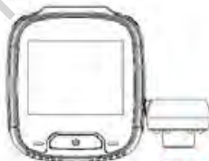
Innenobjektiv, das nach unten gerichtet ist
