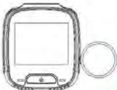
Innenobjektiv, das in die Windschutzscheibe gerichtet ist
