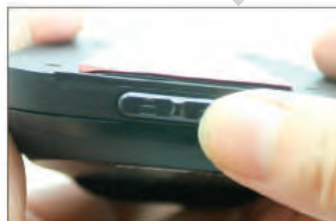
3. Den Riegel nach links drücken
