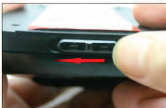
3. Den Riegel nach links drücken
