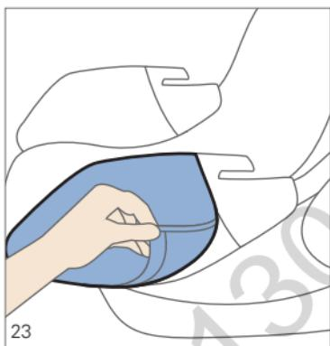
Lösen Sie den Bezug aus dem seitlichen Haken und ziehen Sie ihn wie gezeigt unter der Beckengurtführung hervor.
