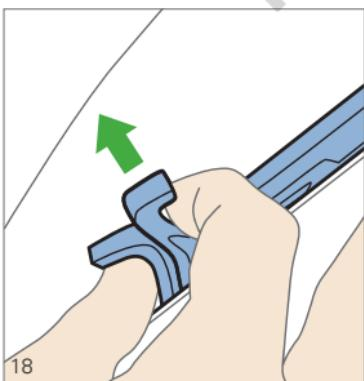
Для снятия солнцезащитного капюшона разблокируйте крепежные крючки по обеим сторонам, скав их, как показано на рисунке. Затем откиньте капюшонвверх и отсоедините его от заднего крепления.
