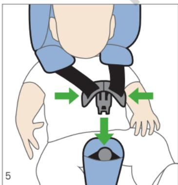
Проведите ремни спереди через плечи ребенка и положите язычки ремня друг на друга. Затем вставьте язычки замка в корпус замка и зафиксируйте их со слышимым щелчком.
