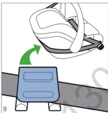
Вытяните плечевую часть ремня безопасности из направляющей автомобиля и положите его вокруг головной части автокресла-люльки. Потяните голубой рычаг на задней стороне автокресла вверх и продените ремень в направляющие, как показано на рисунке. Затем отпустите рычаг. При этом следите за тем, чтобы ремень не был скат.
