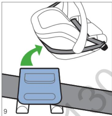
Ziehen Sie den Schultergurt weiter aus der Führung am Fahrzeug und legen Sie ihn um den Kopfbereich der Babyschale.
