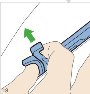
Per rimuovere la copertura parasole sbloccare i ganci di fissaggio su entrambi i lati, premendoli come mostrato. Ruotare la copertura parasole verso l'alto e sganciarla così dall'ancoraggio posteriore.
