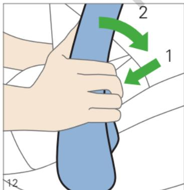
Zum Verstellen des Tragebügels drücken Sie gleichzeitig die beiden grauen Tasten am Tragebügel und bringen Sie den Tragebügel in die gewünschte Position. Achten Sie nach dem Loslassen der Tasten darauf, dass der Tragebügel fest verrastet ist.
