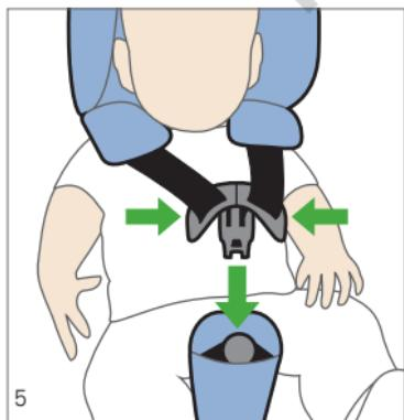
Far passare le cinture sulle spalle del bambino in avanti e posizionare le fibbie l'una sull'altra. A questo punto guidare le lingue di chiusura nel corpo della chiusura e lasciare che si incastri in modo udibile.
