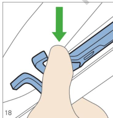
Затем вставьте крепежные лапки в предусмотренные для этого углубления с двух сторон сиденья автокресла. Проверьте правильность соединения.
