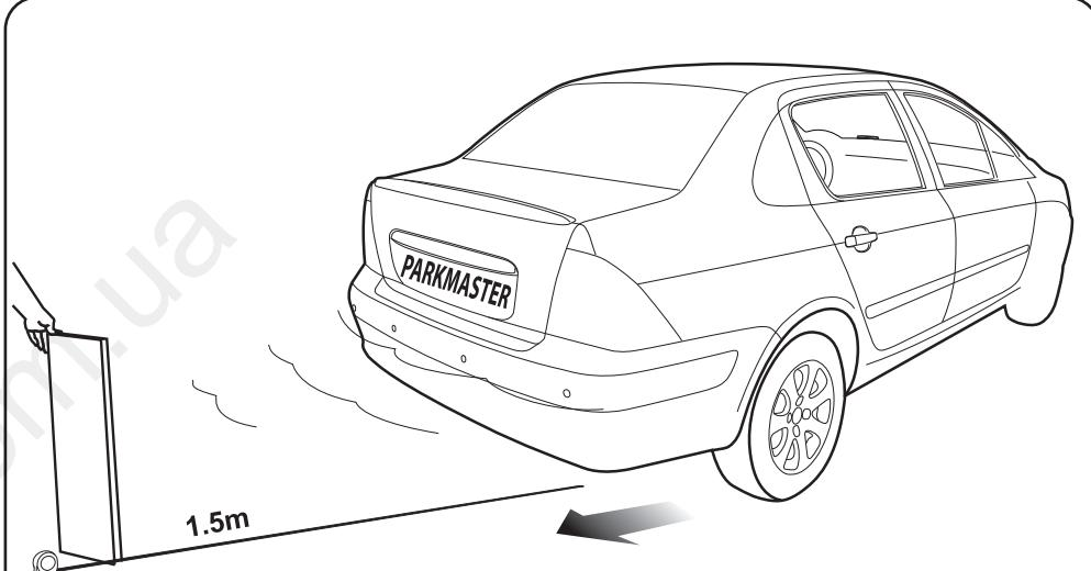
Данный тест возможен с применением плоской деревянной доски размерами 30x100см: держите ее позади автомобиля и двигайтесь задним ходом для проверки каждого датчика системы, как показано на рисунке.
