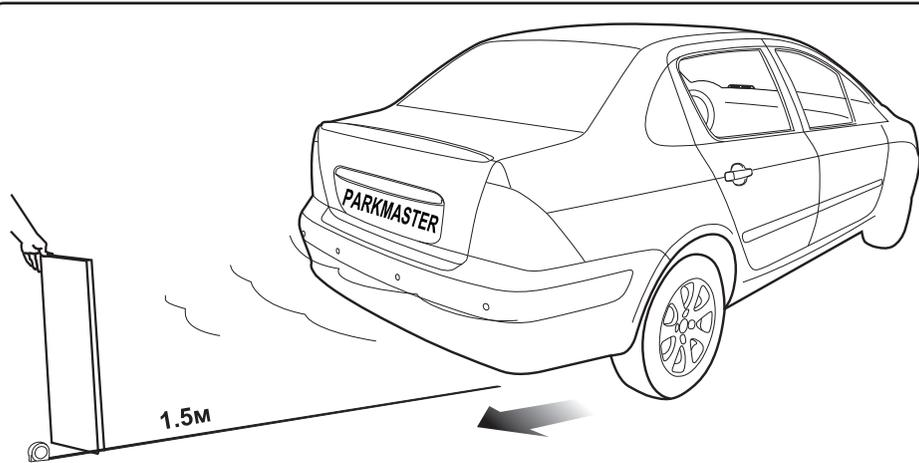
Данный тест возможен с применением плоской деревянной доски размерами 30х100см: держите ее позади автомобиля и двигайтесь задним ходом для проверки каждого датчика системы, как показано на рисунке.
