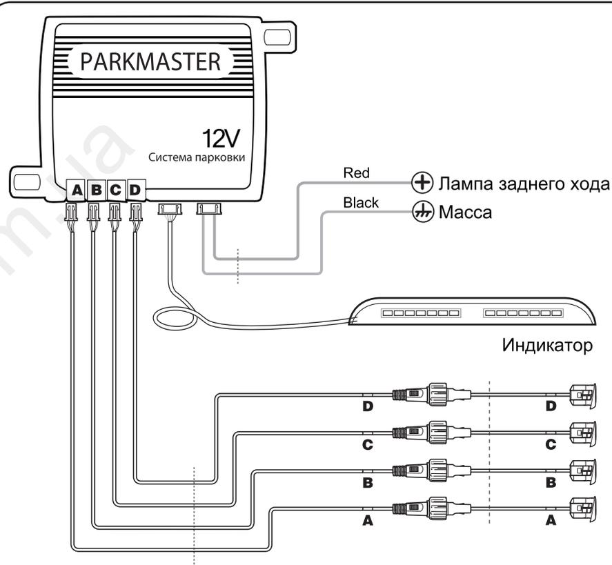
Для автомобилей оборудованных CAN-шиной, используйте дополнительное реле в цепи питания системы парковки.
