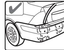
Пожалуйста, мойте датчики под низким давлением воды, после мойки, продуйте датчики сжатым воздухом, для удаления влаги
