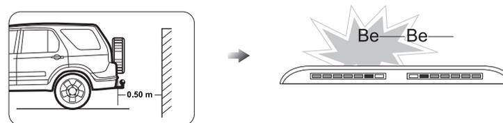
При программировании функции запоминания все ультразвуковые датчики должны быть подключены к системе.
