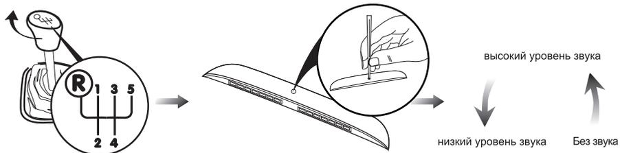
Включите зажигание, и нажмите кнопку регулирования громкости звука, что бы выбрать наиболее подходящий уровень звука или же выключить звук.
