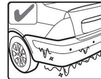
Пожалуйста, очищайте датчики ото льда с помощью горячей воды, продуйте датчики сжатым воздухом, для удаления влаги
