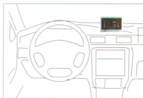
1. Экран должен быть установлен на панели автомобиля в удобном для водителя месте.
