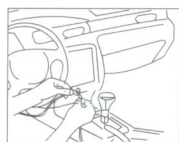
2. Провод питания главного модуля системы подключается к дополнительному проводу питания (ACC) на замке зажигания автомобиля.
