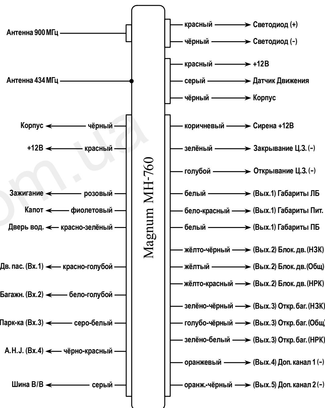
**Выход «Сирена (+)» – коричневый** – подключается к красному проводу сирены. Чёрный провод сирены подключается к корпусу автомобиля.
