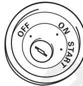
Assenza di posizione ACC
